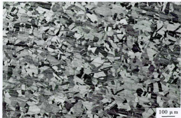
图1 模铸4J36合金20 mm热轧板800 °C 1.5 h退火的组织形貌
